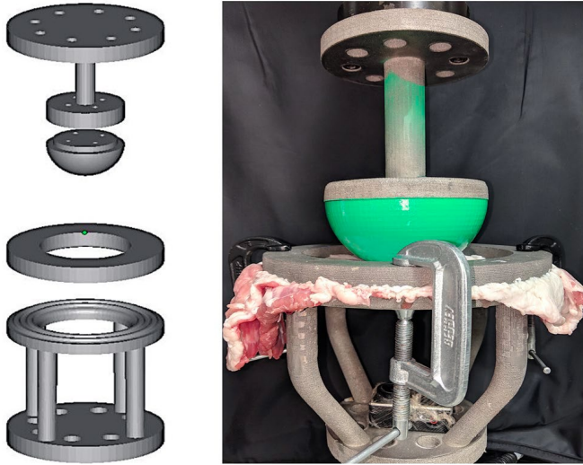
Şekil 2. Bilyalı patlama Aparatı-Sağ-Yeşil renkli plastik kafalı 3D baskılı titanyum. Üst kısım, aşağıdaki halkada tutulan numuneye kuvvet uygulamak için pistonla tutturulmuş küresel bir kafa içerir. Sol: Top-patlama aparatının bilgisayar destekli tasarım (CAD) görüntüsü. Bilyalı patlama aparatının halka çapı 7 cm'dir (renkli şekil online).
